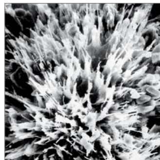
3. Dichtes Kristallgefüge nach 26 Tagen – wasserundurchlässig.
