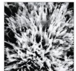
3. Dichtes Kristallgefüge nach 26 Tagen – wasserundurchlässig.
