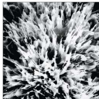
3. Dichtes Kristallgefüge nach 26 Tagen – wasserundurchlässig.
